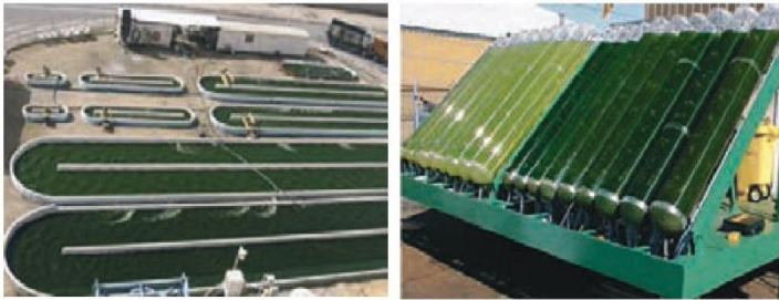
شکل ۱۷- دو نوع فتوبیوراکتور که در آن جلبک تک یاخته‌ای کشت شده است.
